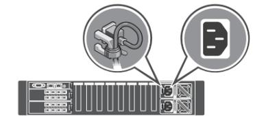
**4** Connect the system to a power source and secure the power cables using the retention strap. 将系统连接到电源并用固定束带固定电源线缆。 Sambungkan sistem ke sumber daya dan amankan kabel daya menggunakan tali penahan. システムを電源に接続し、固定ストラップで電源ケーブルを固定します。 전원 소스에 시스템을 연결하고 고정 스트랩을 사용해 전원 케이블을 고정시킵니다.
