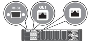
**3** Connect the CMC and I/O modules. 连接 CMC 和 I/O 模块。 Sambungkan CMC dan modul I/O. CMC 모듈과 I/O 모듈을 연결합니다. CMC 및 I/O 모듈을 연결합니다.
