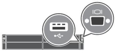
**2** Connect the keyboard, mouse, and monitor (optional). 连接键盘、鼠标和显示器（可选）。 Hubungkan keyboard, mouse, dan monitor (opsional). 키보드, 마우스, 모니터 (옵션)을 연결합니다. 키보드, 마우스 및 모니터(선택 사항)를 연결합니다.
