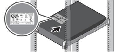
**1** Install the enclosure in the rack and read the system electrical rating information on top of the system. 将机柜装入机架并阅读系统顶部的系统电气规格信息。 Pasang wadah penutup di dalam rak dan baca informasi kelas kelistrikan sistem di bagian atas sistem. エンクロージャをラックに取り付けて、システム上部のシステム電気定格情報を確認します。 랙에 인클로저를 설치하고 시스템 상단의 시스템 전자 등급 정보를 읽어 보십시오.
